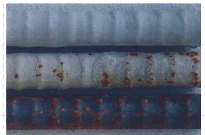
上：アルカードP防錆ペースト塗布 中：ポリマーセメントペースト塗布 下：無塗布
