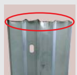
打込作業での変形
