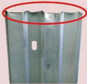
打込作業での変形
