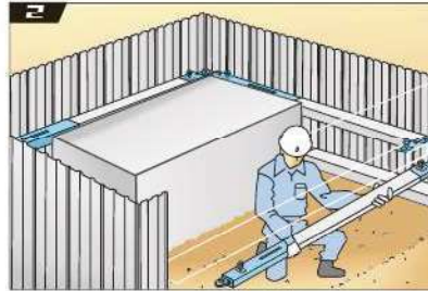
2 下段4隅の連結ピンを外し撤去します。
