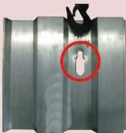
引抜作業での破損
