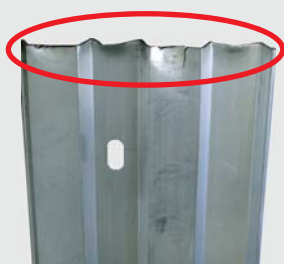
打込作業での 変形
