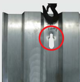
引抜作業での 破損
